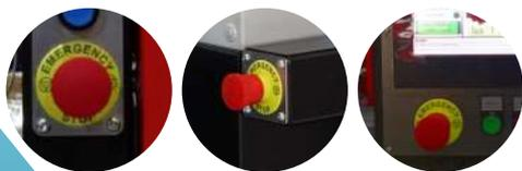
Tiene una serie de pulsadores de emergencia distribuidos entre el interior y exterior del paletizador. Durante el diseño, se analizan la disposición de los mismos, en función de la proximidad y las necesidades que pudiesen tener los operarios.
